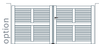
Lames brise vent en partie haute et basse
