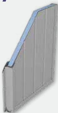
Composée d'un panneau frise isolé finition grain d'orge en aluminium laqué d'épaisseur 27 mm avec un pas vertical de 85 mm ou horizontal de 150 mm (paroi : 0,8 mm pour les coloris standards, 1 mm pour les coloris hors standard, âme isolante : 25,4 mm).
